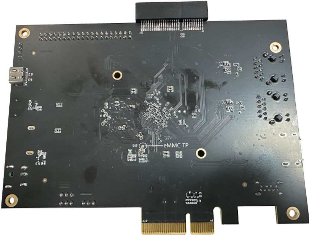
RK3568 PCIe EP DEMO 板上贴有 SPI NOR Flash 和 eMMC 双存储，可以插在通用 PCIe RC 或者 RK PCIe RC 的插槽上供电，还可以用 12V DC 供电，做 PCIe EP 标准卡使用时，必须插在 PCIe RC 插槽上方能正常使用。
