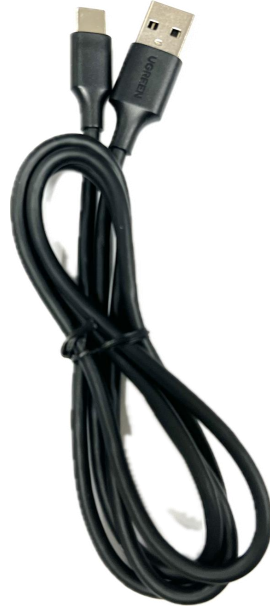
图 2-8 USB-A — USB-C 数据线（适用于 RK3576/RK3588 开发板）
